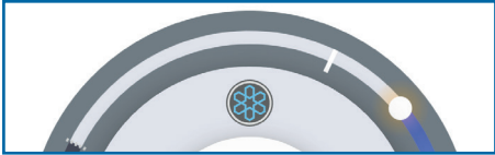
Modalità Estate: TA minore del SET, solo ventilazione
